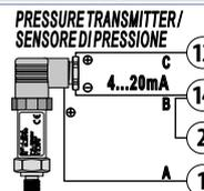
Per segnali normalizzati in corrente 0/4...20 mA con sensore a tre fili.
