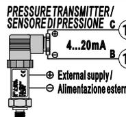
Per segnali normalizzati in corrente 0/4...20 mA con sensore ad alimentazione esterna.
