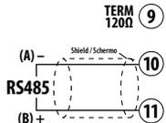
Comunicazione RS485 Modbus RTU Slave isolato galvanicamente dal sensore.
