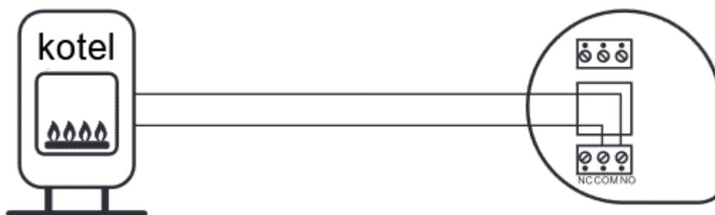
2) Propojení termostatu a elektrické podlahové rohože, max. 5A (s čidlem do podlahy):
