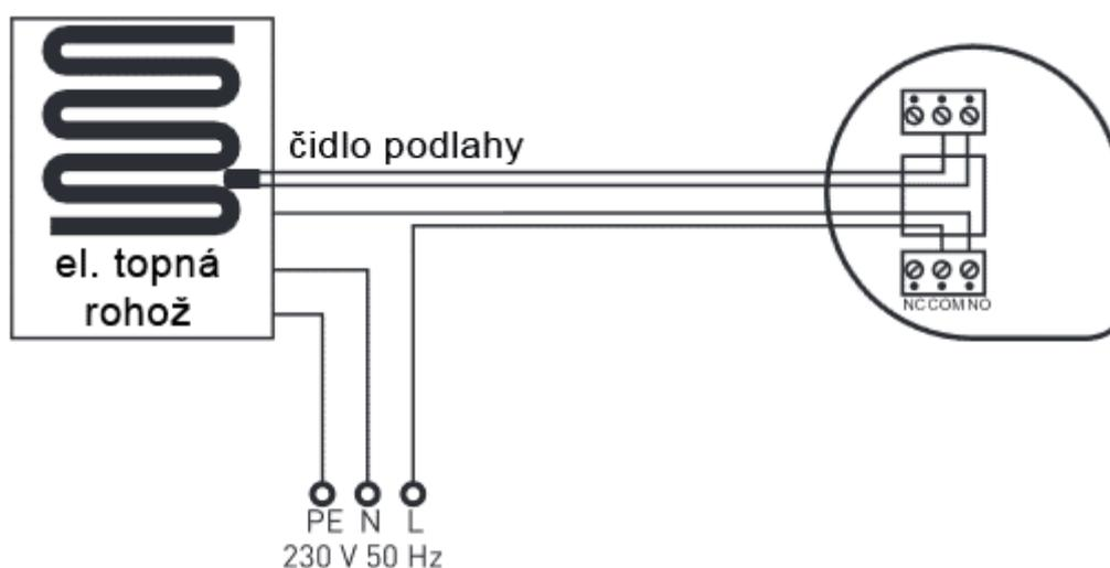
3) Propojení termostatu s libovolným spotřebičem. Fáze spotřebiče je vedena přes relé termostatu. (platí i pro nižší napětí 12V, 24V, 110V):
