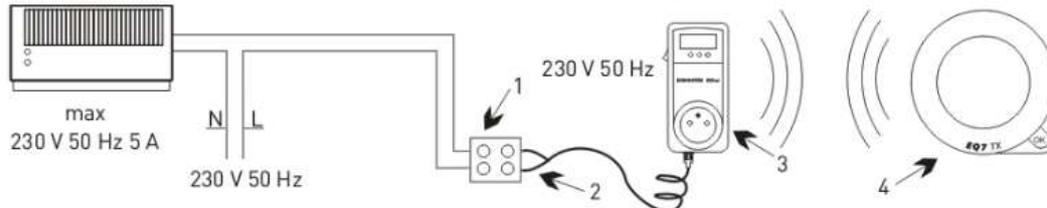
**Kotel:** 1= svorkovnice, 2= výstupní kabel přijímače, 3= přijímač, 4= vysílač EQ7
