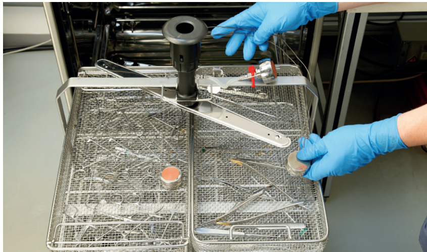
Obr. 2: Měření tlaku během validace procesu myčky a dezinfekce.
