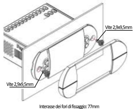
Interasse dei fori di fissaggio: 77mm
